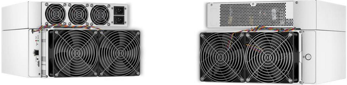
**注意：**1、在运行服务器的过程中，请按照上图的放置方式摆放，即保持平置，以免对服务器造成任何损坏。
