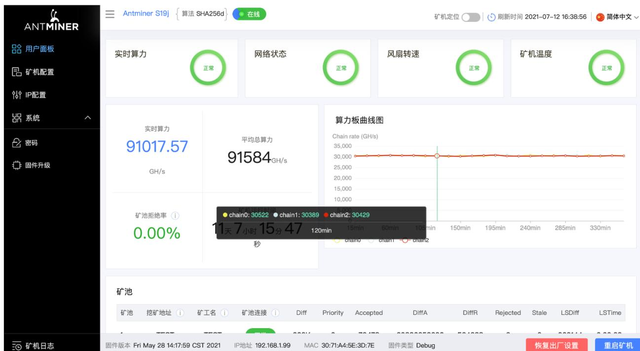
**注意：**S19j 服务器是定频机器，频率为 550 MHz（90T）。当出风口温度达到 85℃时，固件将停止运行，并出现错误提示“over max temp, pcb temp（实际温度）”显示在服务器日志页的底部。同时，用户面板界面的服务器温度变为异常并提示“Temp is too high”。
