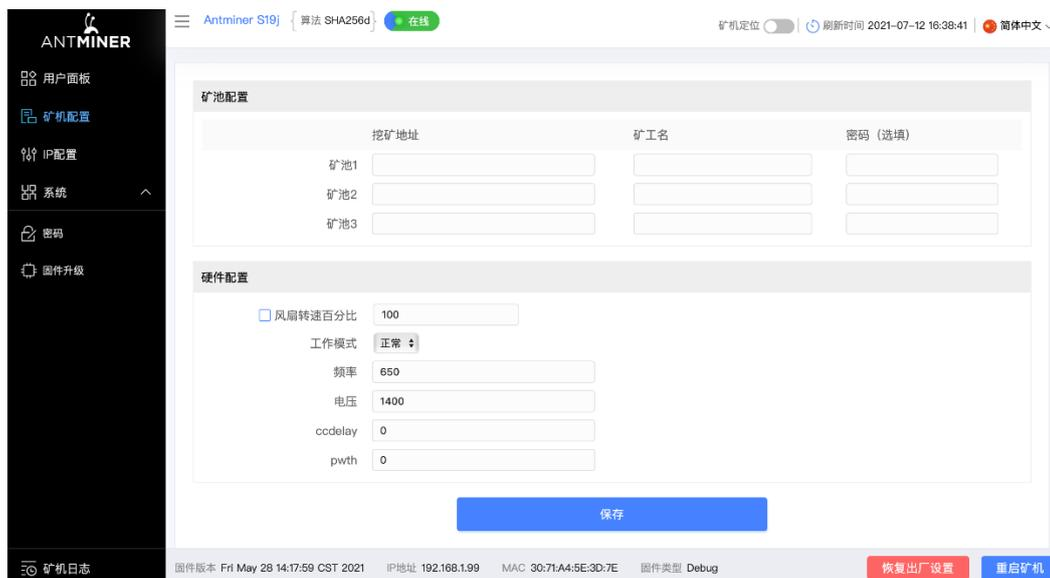
a、点击“服务器配置”进入矿池配置和硬件配置页面；
